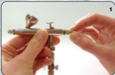
**Gründliche Reinigung (vor längeren Arbeitspausen):** 1. Druckluftzufuhr beenden. Endstück (K) und Nadelklemmmutter (J) abschrauben.
