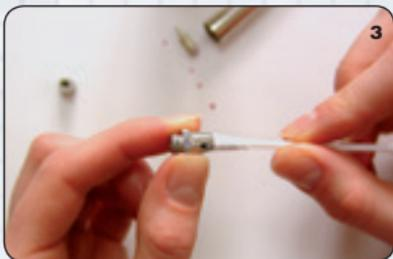
**3.** Luftkopf (A) abschrauben und mit einem Wattestäbchen reinigen.
