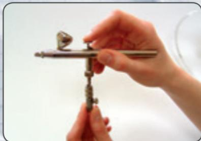
Sluit het apparaat met een schroeffitting\*, insteeknippel\* en/of snelkoppeling NW 2,7 mm\* op een slang\* en een geschikte persluchtbron\* aan.
