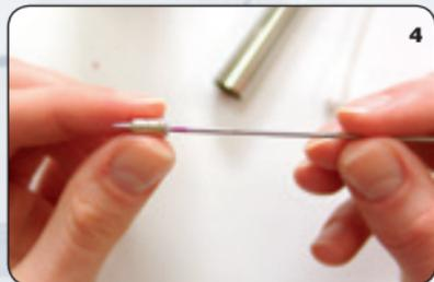
**4.** Rimuovere l'ugello (B) e spingere fuori eventuali residui di colore utilizzando un pennello molto sottile o un ago (H). Controllare che l'ugello o la guarnizione non siano deformati o danneggiati.
