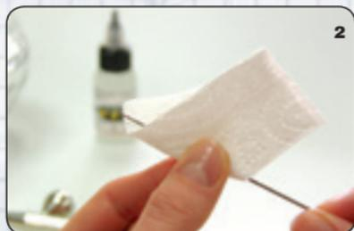
**2.** De naald (H) uittrekken en met een doek en reinigingsmiddel reinigen. De naaldpunt op vervorming controleren.
