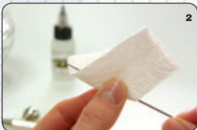
**2.** Nadel (H) herausziehen, mit einem Tuch und Reiniger säubern. Nadelspitze auf Deformierung überprüfen.
