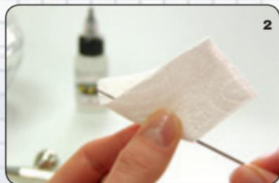
2. Estrarre l'ago (H), pulire con un panno e del detergente. Controllare che la punta dell'ago non sia deformata.
