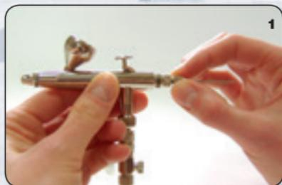
**Grondige reiniging (vóór langere periodes van niet-gebruik): 1.** De persluchtvoevoer uitschakelen. Het eindstuk (K) en de naaldklemmoer (J) losschroeven.
