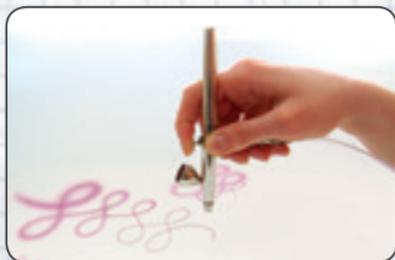
**Spirali:** iniziare con spirali sottili e poco colore, poi passare a più colore e spirali più larghe. Dopodiché ridurre di nuovo la quantità di colore/la distanza.
