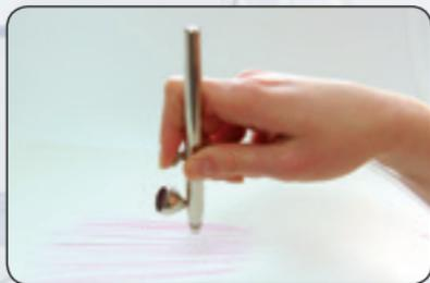
**Linea sottile:** iniziare con l'aria, trascinare indietro il pulsante solo durante il movimento per evitare "punti". Alla fine spingere di nuovo il pulsante in avanti, poi lasciarlo completamente.
