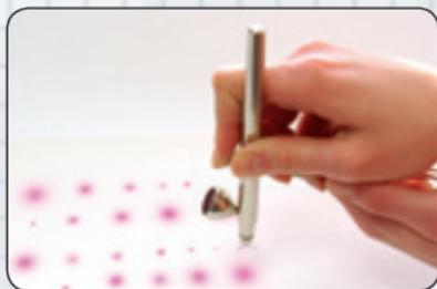
**Sprühpunkte:** 2. Hand zur Stabilisierung benutzen. Mit Luft beginnen, dann Hebel vorsichtig ein wenig nach hinten ziehen. Für größere Punkte mehr Abstand, mehr Farbe.
