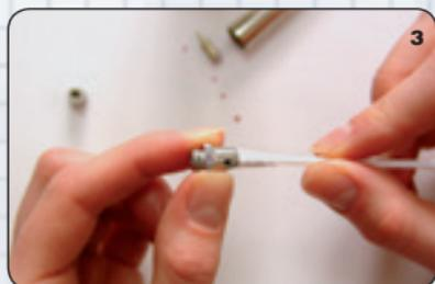
**3.** De luchtkop (A) losschroeven en met een wattenstaafje reinigen.
