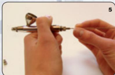
**5.** Inserire e avvitare l'ugello (B) nel puntale dell'ugello (A). Spingere il pulsante (E) verso il basso ed inserire cautamente l'ago (H) fino ad arresto. Riavvitare il dado di serraggio dell'ago (J) e l'estremità (K).
