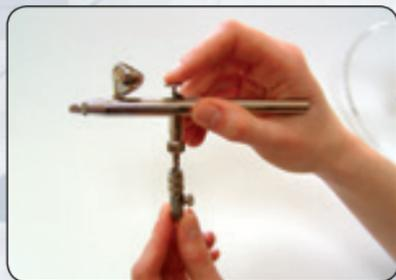
Schließen Sie den Apparat mit Schraubanschluss\*, Stecknippel\* und/oder Schnellkupplung NW 2,7 mm\* an einen Schlauch\* und eine geeignete Druckluftquelle\* an.
