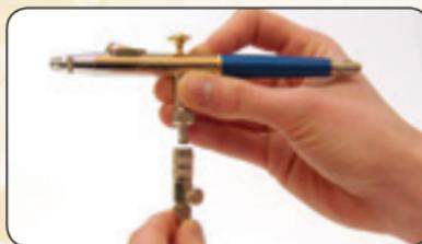
Schließen Sie den Apparat mit Schraubanschluss\* oder Schnellkupplung NW 2,7 mm\* an einen Schlauch\* und eine geeignete Druckluftquelle\* an.
