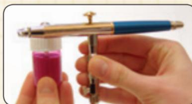
Die Geräte Grafo T2 und T3 verfügen über einen Seitenanschluss-Becher (S/T), der an das Gerät anzustecken bzw. anzuschrauben ist.
