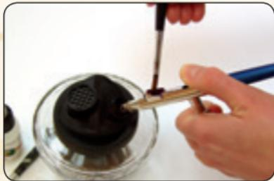
**Tussentijdse reiniging:** de verf opgebruiken, de resten met water en/of een geschikt reinigingsmiddel en een penseel of wattenstaafje oplossen en verstuiwen.
