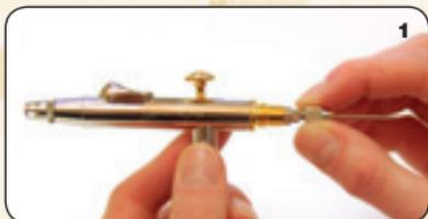
**Grondige reiniging (vóór langere periodes van niet-gebruik):** 1. De persluchtvoer uitschakelen. Het eindstuk (L) en de naaldklemmoer (K) losschroeven.
