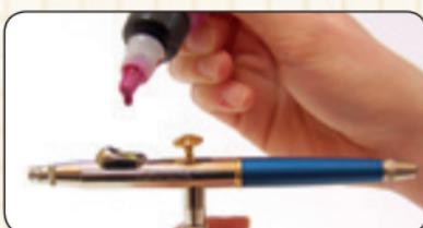
Si possono utilizzare tutti i colori o vernici per aerografia avendo una consistenza simile al latte, il colore va poi diluito a seconda dei casi.
