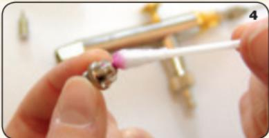
**Zwischenreinigung:** Farbe ausspritzen, Reste mit Wasser und/oder geeignetem Reinigungsmittel und Pinsel/Wattestäbchen lösen und ausspritzen.
