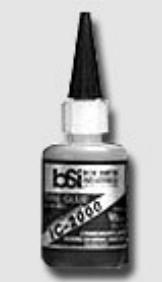
Cyanoakryl wzmocniony gumą. Ten czarny w kolorze CA tworzy spoiny elastyczne, bardzo odporne na uderzenia i wibracje, łączy nieporowate powierzchnie. W modelarstwie jest spokiem idealnym do wklejania ścianek silników, ramek mocujących serwa - wewnętrz kompozytowych kadłubów. Wiąże w czasie 20-40 sekund. Proces ten można przyspieszyć używając katalizatora INSTA-SET. Po zastygnięciu IC-2000 pozostaje wytrząsająco elastyczny by obrabiąć go nożykiem modelarskim.
