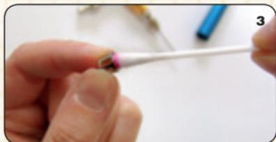
**3.** De naaldkap (A) losschroeven en met een wattenstaafje reinigen.
