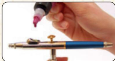
Si possono utilizzare tutti i colori o vernici per aerografia aventi una consistenza simile al latte, il colore va poi diluito a seconda dei casi.
