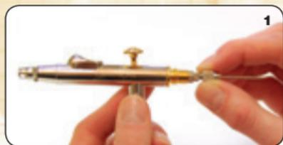
Druckluftzufuhr beenden. Endstück (L) und Nadelklemmmutter (K) abschrauben.
