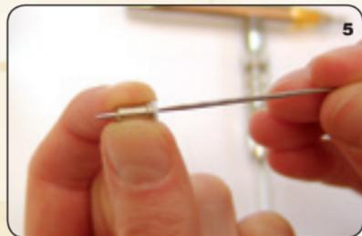
**5.** Rimuovere l'ugello (C) e spingere fuori eventuali residui di colore utilizzando un pennello molto sottile o un ago (I). Controllare che l'ugello o la guarnizione non siano deformati o danneggiati.
