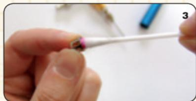
2. Retirer l'aiguille (I), la nettoyer au chiffon et au produit nettoyant. Contrôler que la pointe de l'aiguille ne présente pas de déformations.
