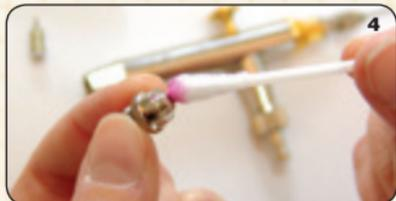
**4.** De luchtkop (B) losschroeven en reinigen.
