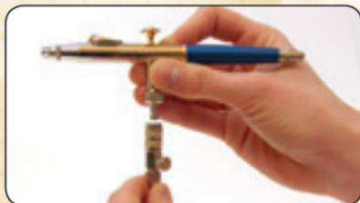
Sluit het apparaat met een schroeffitting\* of snelkoppeling NW 2,7 mm\* aan op een slang\* en een geschikte persluchtbron\*.
