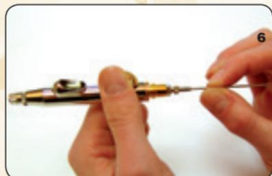
**6.** Inserire e avvitare l'ugello (C) nel puntale dell'ugello (B). Riavvitare il puntale dell'ago (A). Spingere il pulsante (F) verso il basso ed inserire cautamente l'ago (I) fino ad arresto. Riavvitare il dado di serraggio dell'ago (K) e l'estremità (L).
